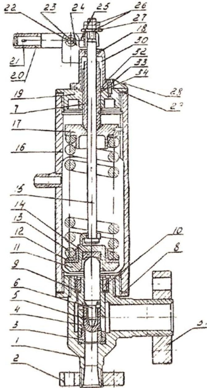
Рисунок 1 – Общий вид клапана
